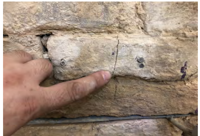
Lesioni di elementi alla pressione massima raggiunta.
