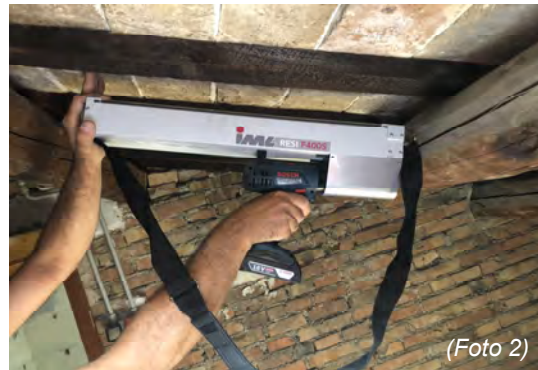
Prova eseguita lateralmente alla trave del solaio di copertura (Foto 2) Trave resistente alla perforazione, non sono stati rilevati punti di debolezza.
