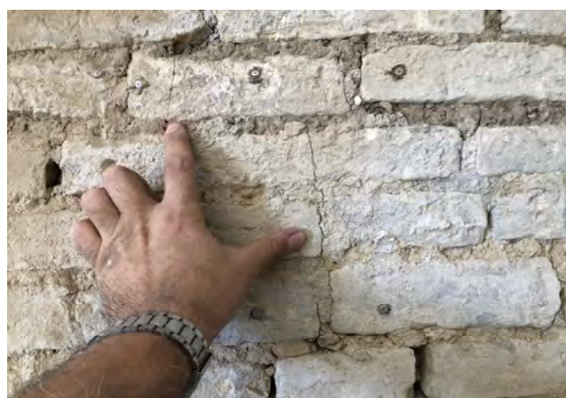
Lesioni di elementi alla pressione massima raggiunta.
