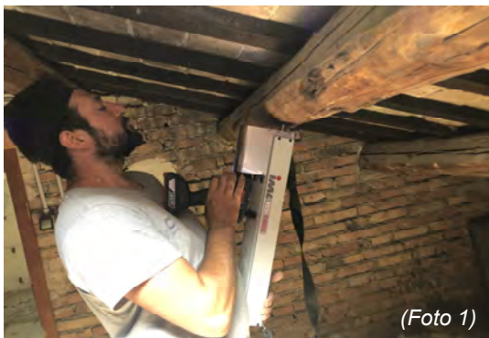
Prova eseguita lateralmente alla trave del solaio di copertura (Foto 2) Trave resistente alla perforazione, non sono stati rilevati punti di debolezza.
