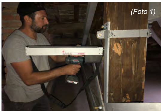
Prova eseguita lateralmente al monaco della capriata lignea (Foto 2) Trave resistente alla perforazione, sono stati rilevati dei punti di debolezza alle seguenti profondità 3, 4,5 e 15 cm.
